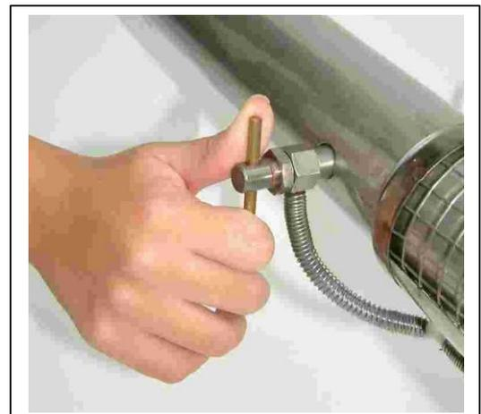
Comprobar ajuste del inyector
